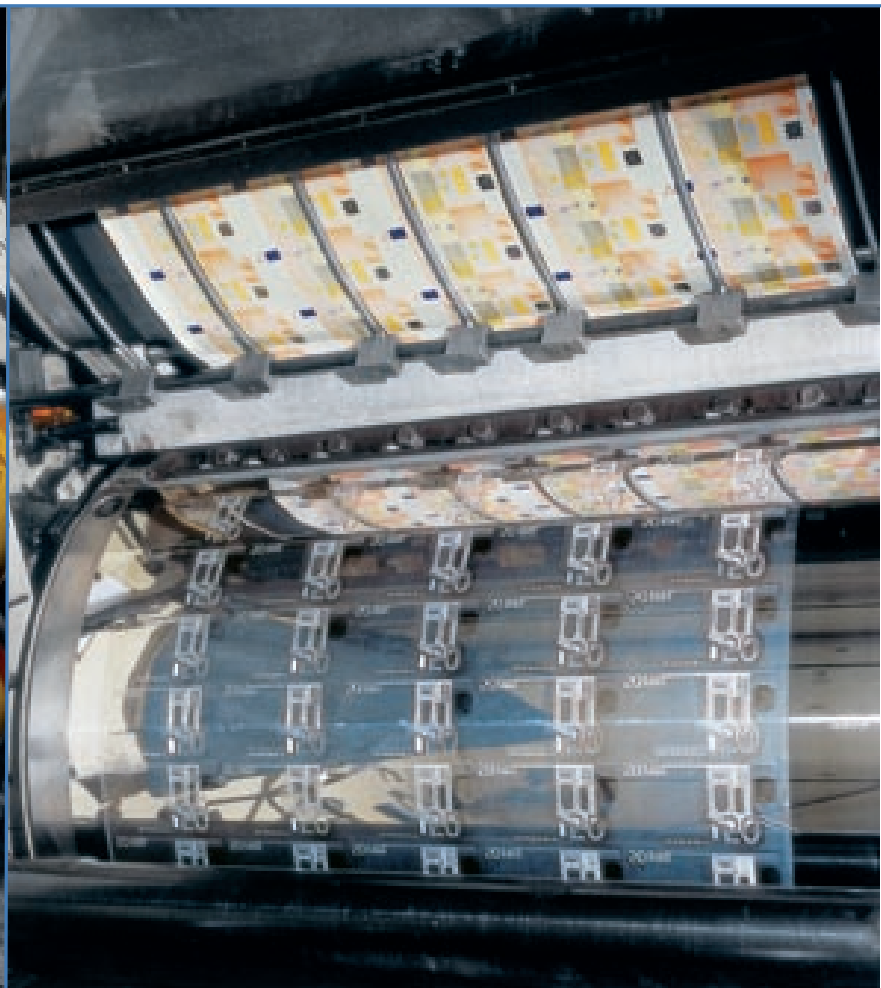
Plattencylinder einer Tiefdruckmaschine für den Druck von 50-€-Banknoten
