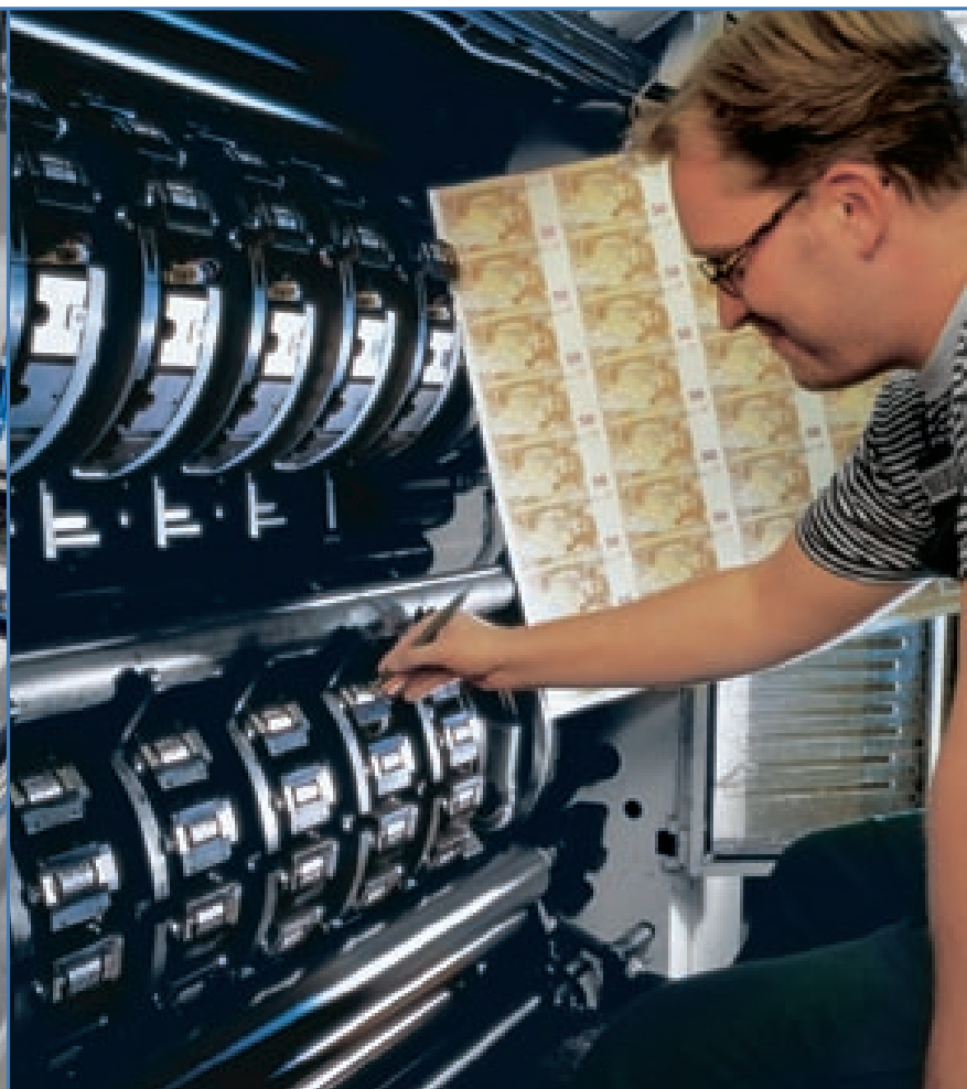
Ein Nummerierwerk. Jede Banknote ist mit einer einzigartigen Seriennummer versehen.
